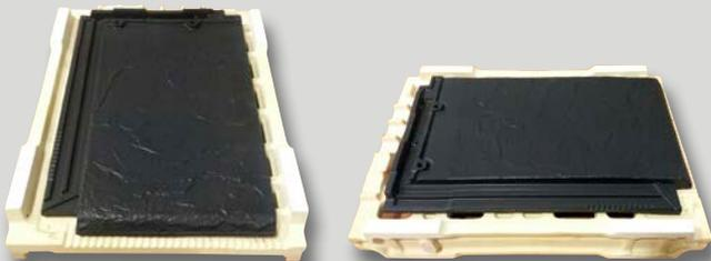
Soportes refractarios unitarios en H que permiten cocer las tejas de forma individual a alta temperatura, logrando una definición perfecta.
